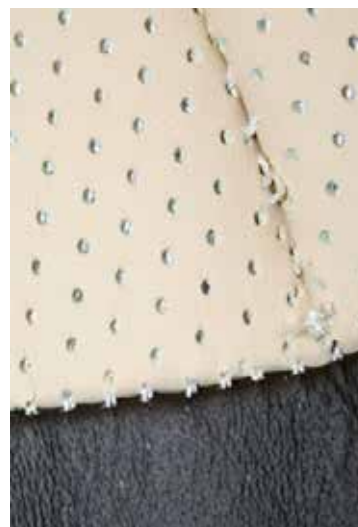
Insbesondere am Fahrersitz, aber auch an den anderen Bezügen zeigte sich die fehlerhafte Verarbeitung der Nähte.
