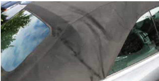
Der Verdeckbezug eines 12 Jahre alten Audi A4 Cabriolet (Bild oben) zeigt vergleichbare Gebrauchsspuren wie das erst 22 Monate alte Verdeck eines VW Golf VI Cabriolet (Bild links). Dennoch können beide Fälle als nicht reklamationswürdig eingestuft werden.
