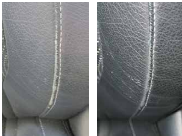
An der Kappnaht des Fahrersitzes ist auf zehn Zentimeter Länge weder der Top-Coat noch die Deckschicht des Leders vorhanden. Links zeigt den Zustand nach 17 000 Kilometern Nutzung, rechts nach 26 400 gefahrenen Kilometern.
