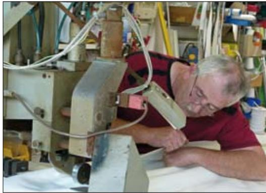
Reiner Kreis, seit 2006 in Fa. Schmidt angestellt; Kunststoff- und Schwergewebe Konfektionär, beim Einschweißen eines Keders in eine 20 m Dachplane (Zeltplane)
